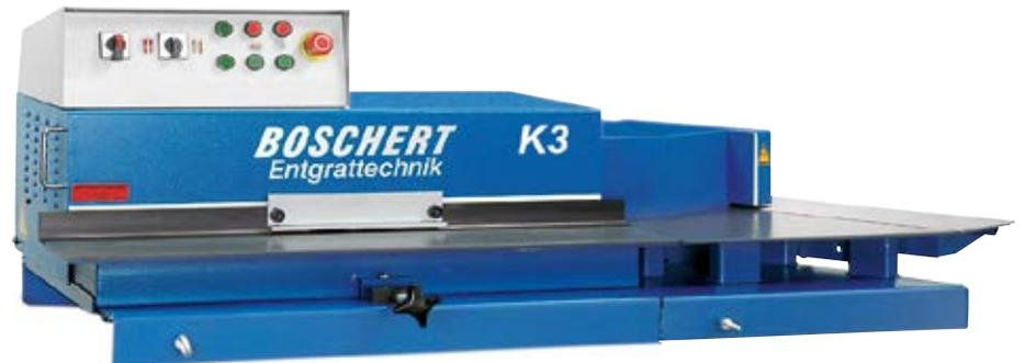
**K3** für das Entgraten gerader Blechkanten und zusätzlich von Radien und kleinen Ausbrüchen an Blechaußenkanten
