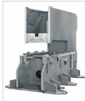
Die massiv geschweißte Stahlkonstruktion des Gestells gewährleistet auch beim Stanzen von Blechdicken bis zu 6,4 mm höchste Qualität.
