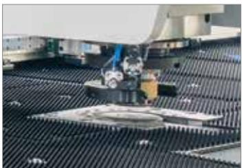
Indexeinrichtung sowie automatische Abstreiferhöhereinstellung
