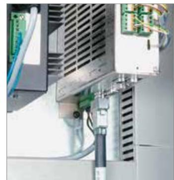
Steuerung mit Speichererweiterung. USB und LAN RJ 45 für Netzwerkanschluß. Fernwartung über Internet möglich.
