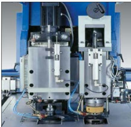
Robuste Bauweise der Stanzköpfe mit Gleichstrommotor und Messsystem
