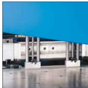
Nachsetzen bis zu 10 Meter und Zangenverfahren ohne Blechberührung; 2 robuste Spannzangen für Bleche bis zu 200 kg (bis auf 4 Zangen erweiterbar); Ausführung der Zangen bis 7 mm oder 12,7mm je nach Bedarf wählbar (Standard)
