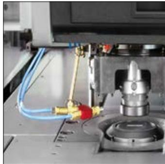
Sprühvorrichtung zu Standzeitverlängerung, vor allem beim Nibbeln in Edelstahl und bei Aluminium zur Verhinderung der Aufbauschneide
