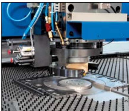
Indexiereinrichtung sowie automatische AbstreiferhöhenEinstellung am Rotationskopf
