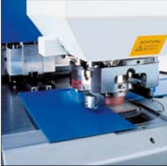
L-Blech zum Bearbeiten von Kleinteilen und bereits gekanteten Blechen (Standard)
