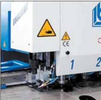
Gewindeschneid- und Bohreinrichtung für Gewinde M3 bis M12, sowie kleine Bohrungen in dicke Bleche
