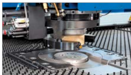
Indexiereinrichtung sowie automatische Abstreiferhöhen-einstellung am Rotationskopf
