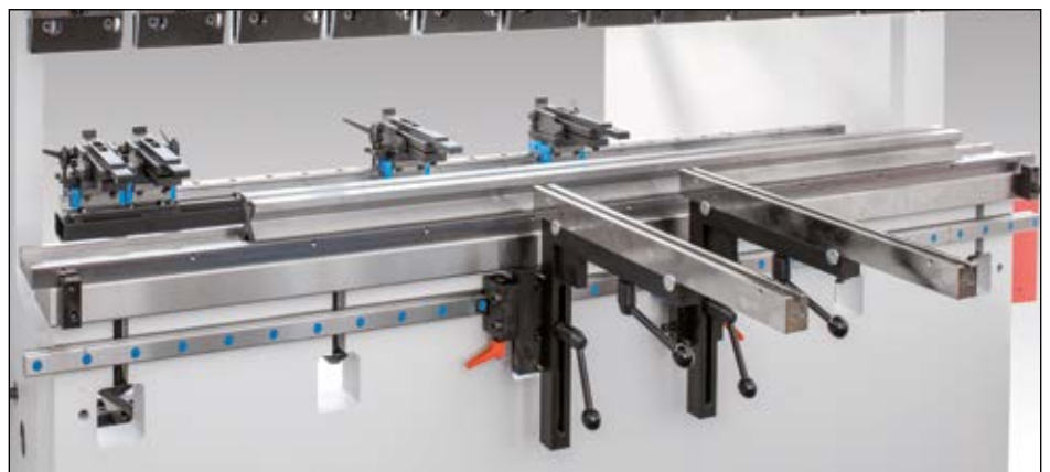
2 seitlich verstellbare Tiefenansläge / optional 4 / optional verschiebbare Vorderansläge
