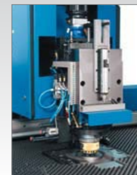
Construction robuste avec moteur à courant continu et système de mesure
