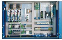
Armoire de commande permet un accès facile aux différents composants électriques tels que: ventilateur, transformateur, etc.
