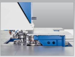
Avec notre changeur d'outils, il est possible d'atteindre des temps de changement de 3 à 5 secondes. Avec le revotool, le temps de changement peut descendre sous la seconde.
