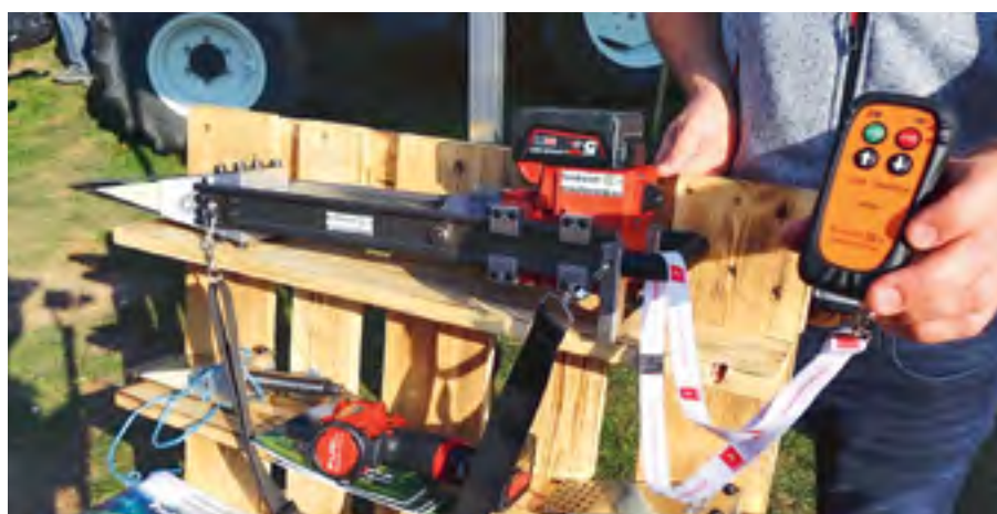
Der Fällkeil «TR300» von Forstreich kann über Funk aus einer sicheren Distanz von bis zu 100 m bedient werden.
