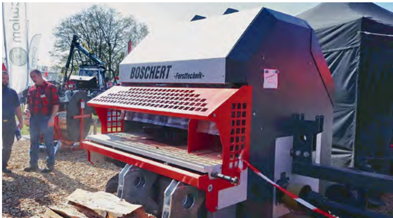
Die Hochleistungs-Brennholzsäge «RS 703 VarioCut» von Boschert arbeitet mit horizontalem Beschickungsrotor und bis zu drei Sägeblättern.
