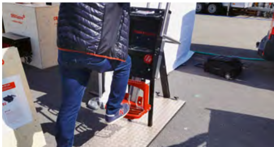
Die dynamische Trittstufe «Grifa softstep» wird beim Aufsteigen automatisch eingefahren.
